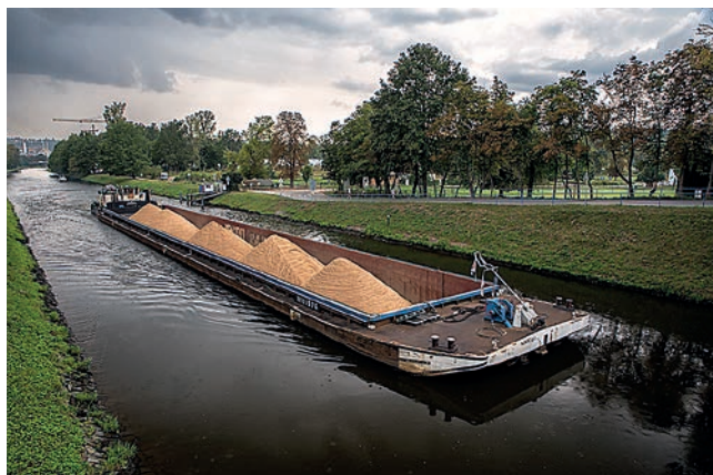
Kamenivo pro výrobu betonu bylo možné dopravovat výhradně lodní dopravou
